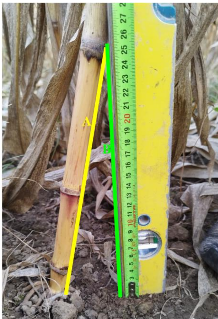
10. ábra: A dőlésszög meghatározása (Vereb, 2023, saját fotó)
