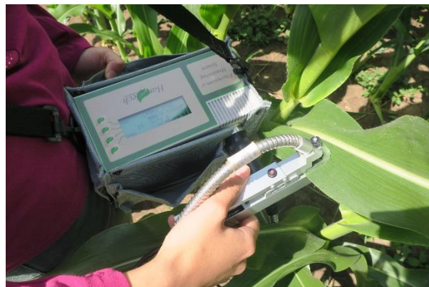
8. ábra: Fluoresszencia mérés
