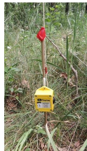
7. ábra Tinytag Plus 2 (TGP-4500) mikroklímamérő egy mocsári kardvirág példány mellett.
