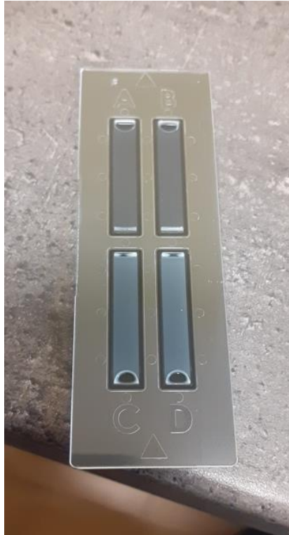
10. kép: Lactochip tárgylemez, benne a végigfutott tejmintákkal
