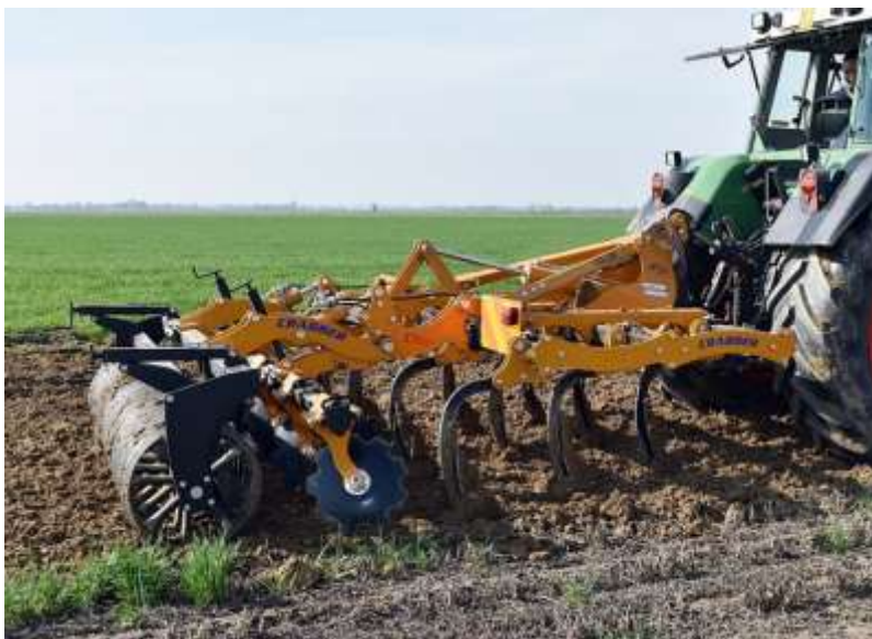
15. ábra Kultivátor munka közben (Forrás: Agroinform, 2024) ( http15 )
