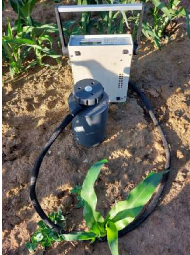
20. ábra: PP Systems EGM-4 infravörös szén-dioxid gázanalizátor (Forrás: Saját kép, 2023)
