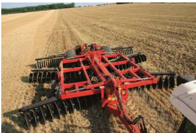
16. ábra Tárcsával történő tarlóhántás esetén a talaj felső rétegében történik a keverés (Forrás: Axiál, 2024) ( http16 )
