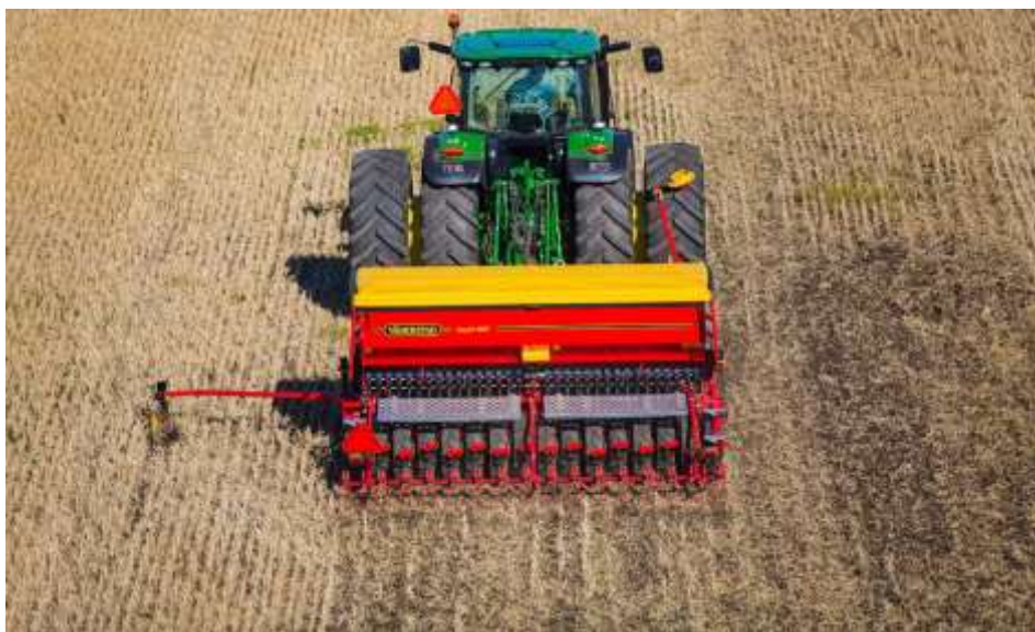
14. ábra Talajvédelem érdekében alkalmazott direktvetés (Forrás: Väderstad, 2023) ( http14 )
