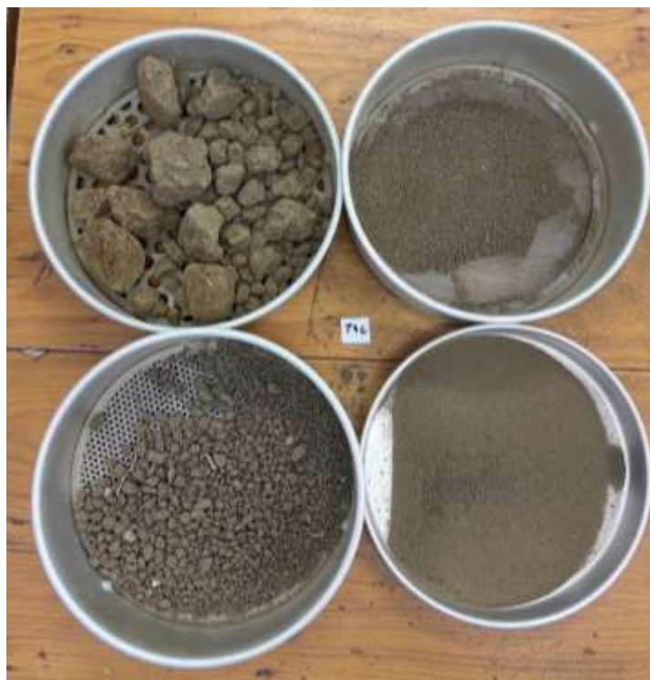
19. ábra: Szitasor különböző talajfrakciókkal (Forrás: Saját kép, 2023)
