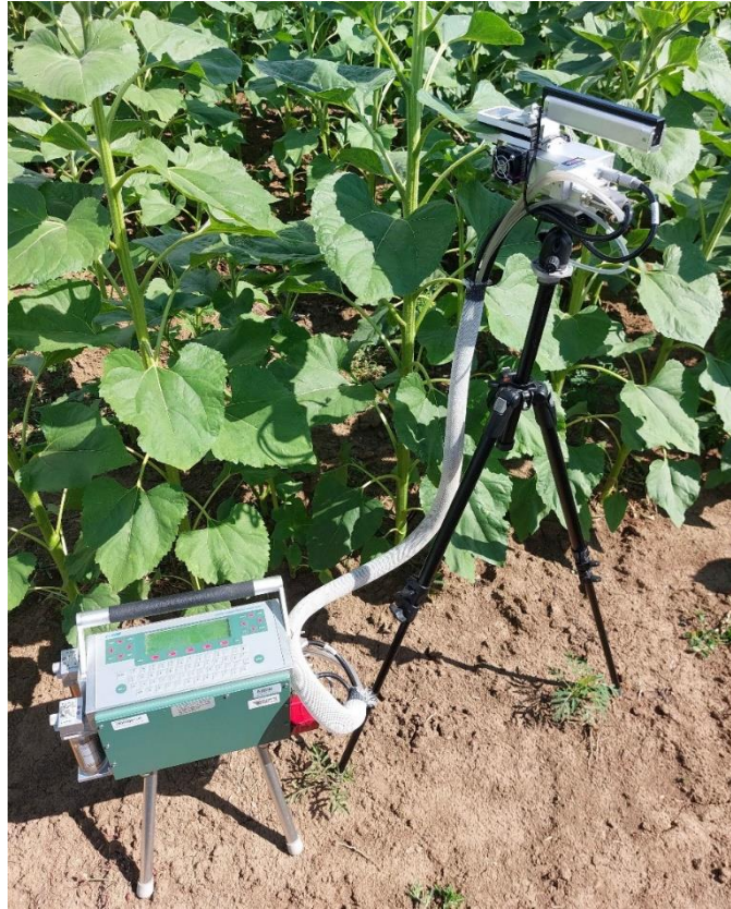
8. ábra. Fotoszintézis és transzspiráció mérése napraforgó táblában Li-6400-zal
