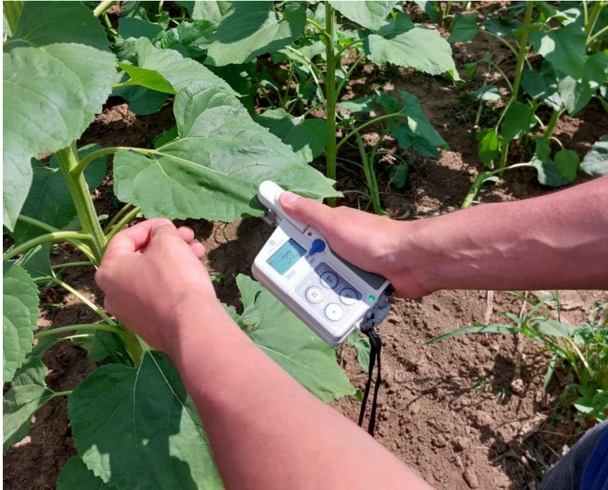
7. ábra. Klorofill mérése napraforgó táblában SPAD-502-vel
