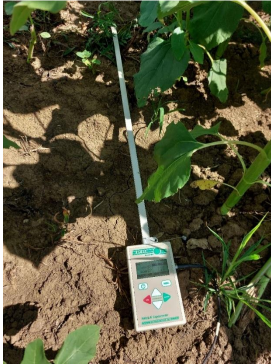
9. ábra. LAI mérése napraforgó táblában Accupar LP-80 ceptométerrel
