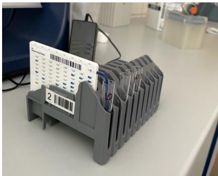
6. ábra: A bioMérieux gyártótól származó DensiCheck berendezés, mellyel a baktériumok koncentrációját mértük (Forrás: Saját fotó)
