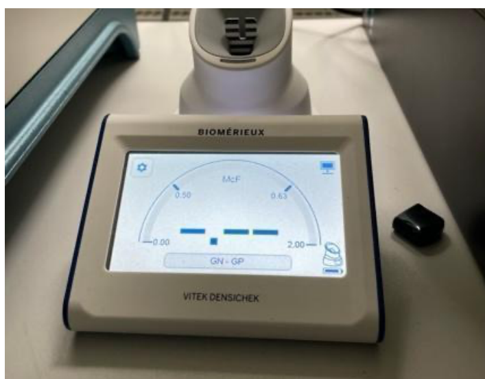
6. ábra: A bioMérieux gyártótól származó DensiCheck berendezés, mellyel a baktériumok koncentrációját mértük (Forrás: Saját fotó)
