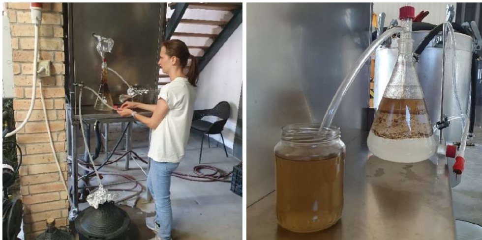
14. ábra: Illóolaj leválasztás és már leválasztott francia levendula illóolaj (Forrás: saját felvétel)
