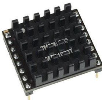
9. ábra MTD1020T hőmérséklet szabályozó (Forrás: www.thorlabs.com )
