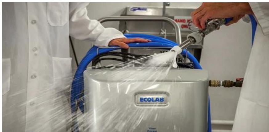
6. ábra magasnyomású paneles mosó-fertőtlenítő (forrás: Ecolab)
