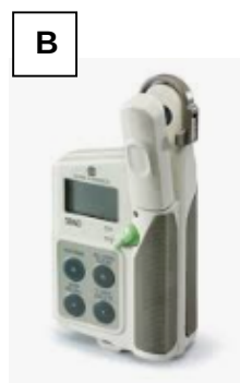
2. ábra: a biofoton emisszió (Nightshade LB 985) (A) és a relatív klorofilltartalom (SPAD 502) (B) mérésére szolgáló eszközök
