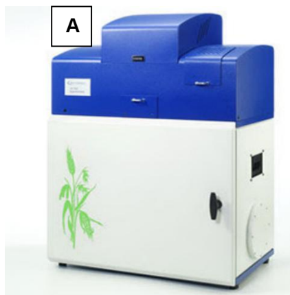
2. ábra: a biofoton emisszió (Nightshade LB 985) (A) és a relatív klorofilltartalom (SPAD 502) (B) mérésére szolgáló eszközök
