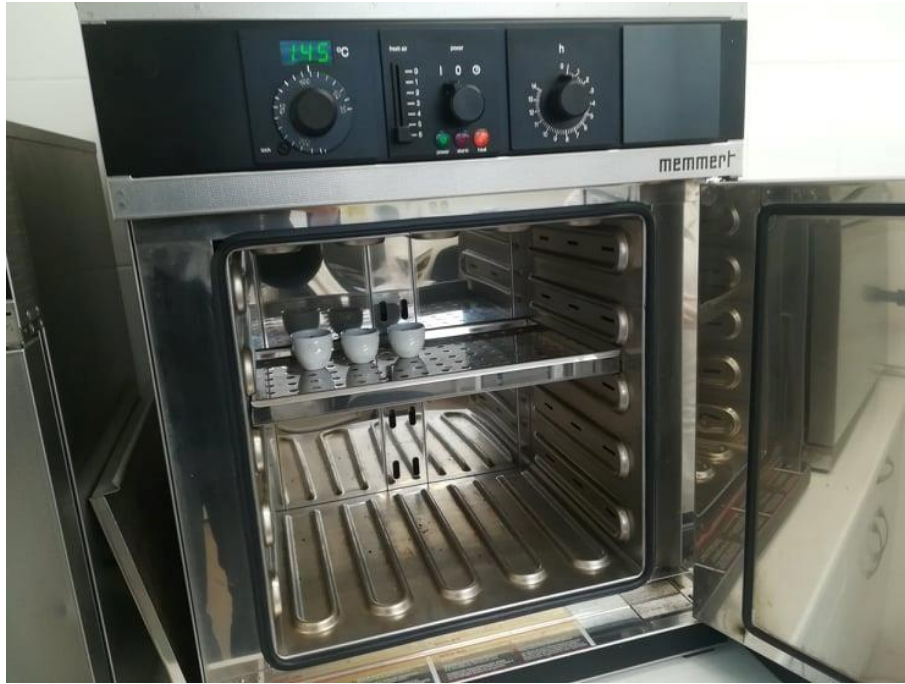
3. ábra: Szárítószekrény komposzt mintával (Forrás: saját készítésű fotó)
