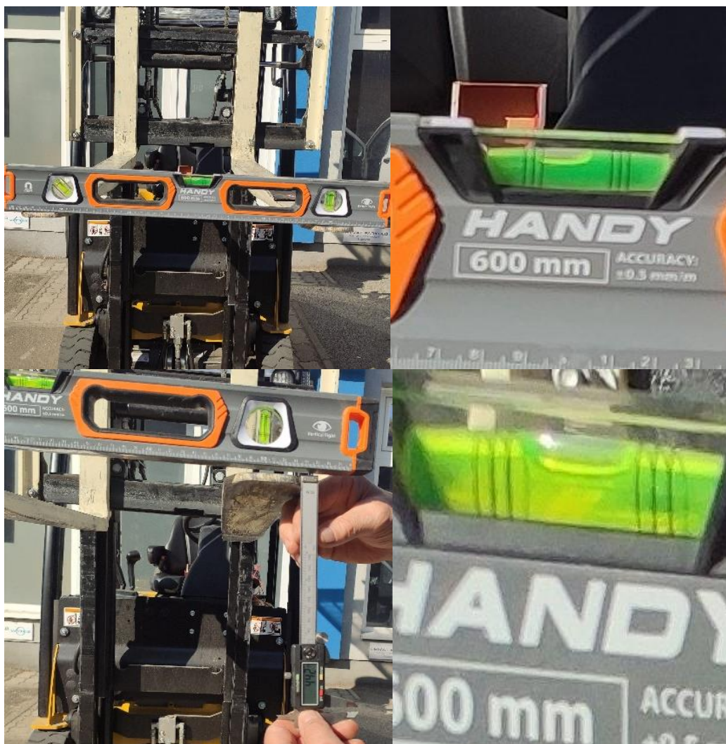
34. ábra: Villalap lehajlás mérése. Forrás: saját készítés.
