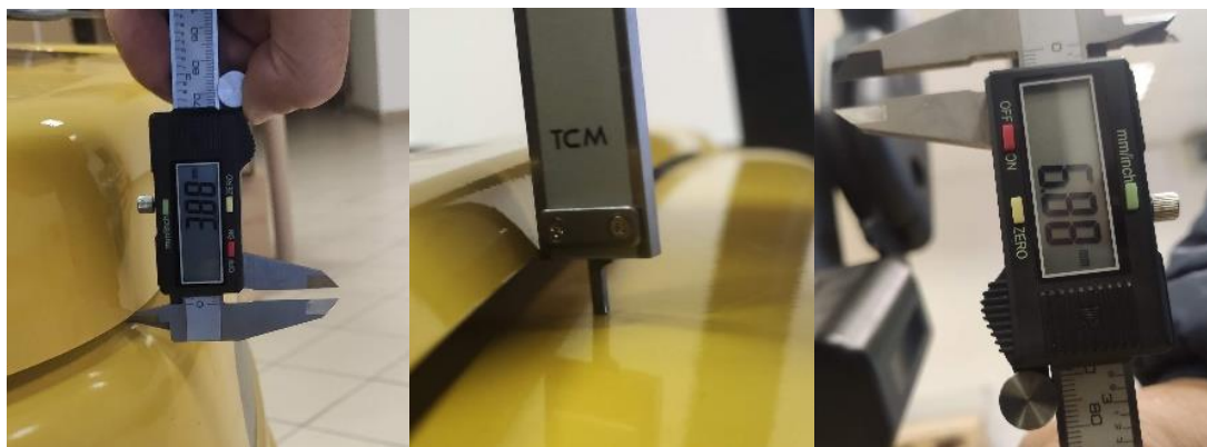
30. ábra: Burkolat távolságok mérése. Forrás: saját készítés.
