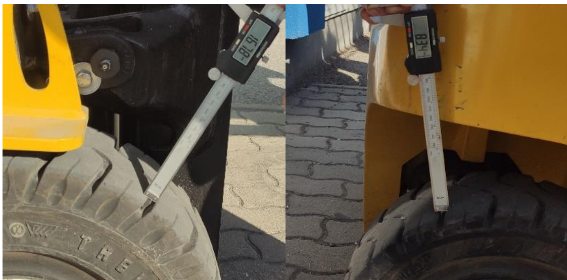
35. ábra: Gumiprofil mélység mérése. Forrás: saját készítés.
