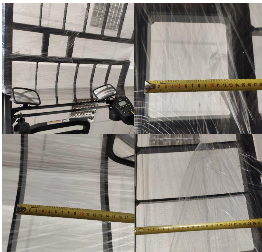
28. ábra: Védőtető mérése. Forrás: saját készítés.
