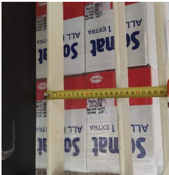
29. ábra: Rakománytámasztó toldat mérése. Forrás: saját készítés.
