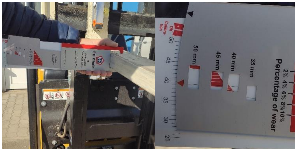
33. ábra: Villakopás mérése. Forrás: saját készítés.
