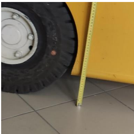
31. ábra: Lábvédelem mérése. Forrás: saját készítés.
