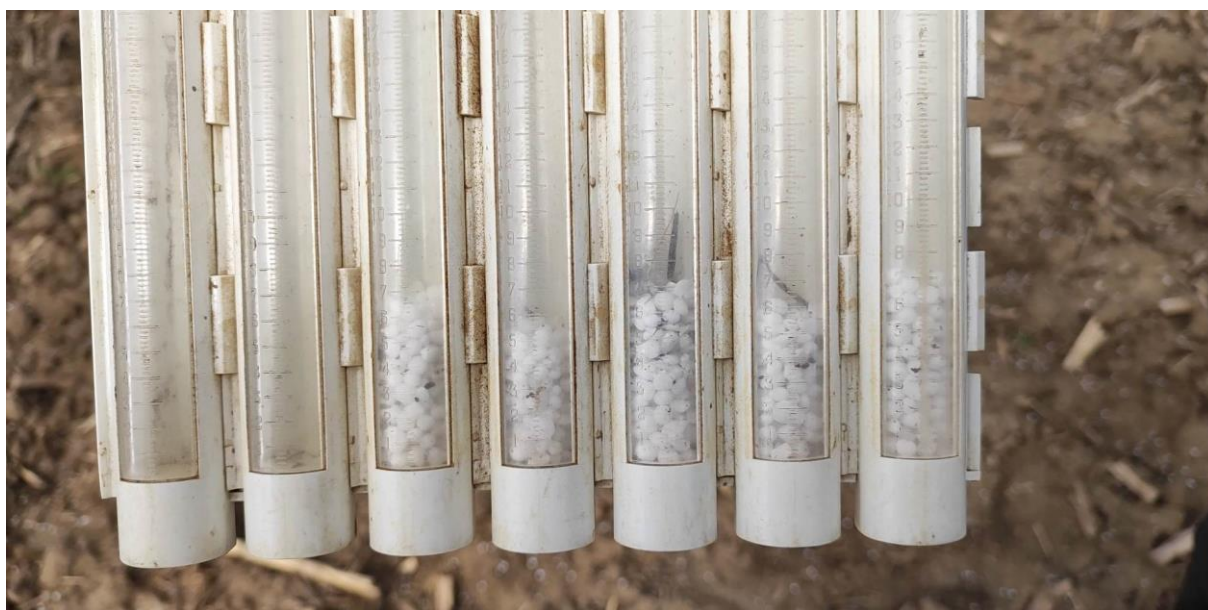
6. ábra Műtrágyázási szóráskép ellenőrzése Forrás: Saját kép
