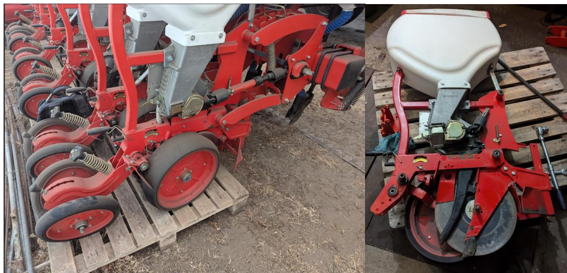
14.ábra: A vetőkocsi felszerelve(bal) és szétszedett állapotban (jobb)
