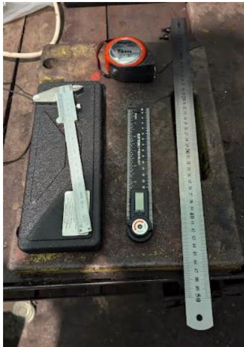
16.ábra: Mérőszerszámok, tolómérő(bal), szögmérő (középső), vonalzó(jobb), mérőszalag (felső)
