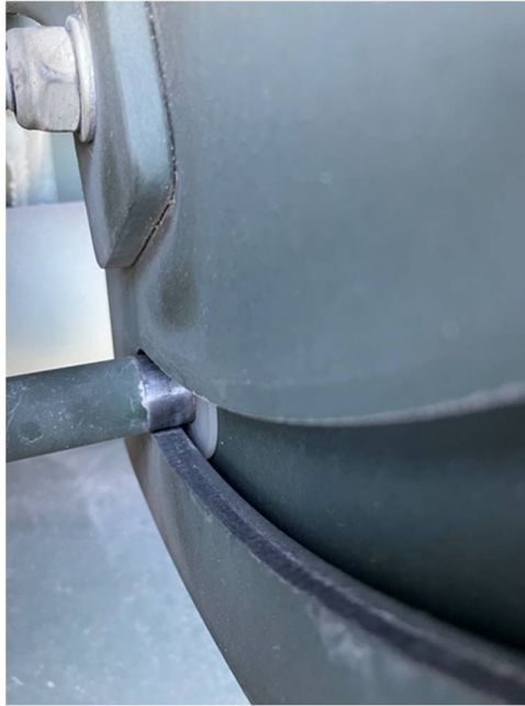
21. ábra A HT 51-96 hatósági jelzésű ÜTG-18 feljárólétra kiemelő szerkezet íves pályája és a súrlódó csap – kenőanyag nélkül. Az íves pályán megvezetett csappal a létrát a tartály döntött falától függőleges állásba lehet kiemelni (forrás: Saját felvétel)
