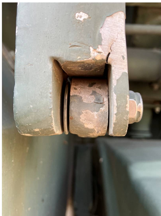
19. ábra A HT 51-96 hatósági jelzésű ÜTG-18 feljárólétra csuklója, amely előírt zsírkenésű hely. Kenőanyagnak nyoma sincs, ellenben a negatív saroktól (a műszaki gyakorlatban ismert feszültséggyűjtő hely) elindult törés már előrehaladott állapotban van. A feljárólétra napi használatban van a kötelező napi mérőléces készletellenőrzés végett. (forrás: Saját felvétel)
