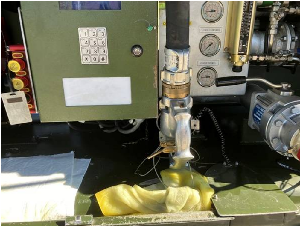
23. ábra ÜTG-18 kezelőszekrény hajtóanyaggal szennyezett felitatólapokkal (forrás: Saját felvétel)
