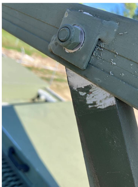
20. ábra A HT 51-96 hatósági jelzésű ÜTG-18 felső biztonsági korlát egyik csuklója, amely előírt zsírkenésű hely. Kenőanyag nem található, fém a fémén súrlódik (forrás: Saját felvétel)
