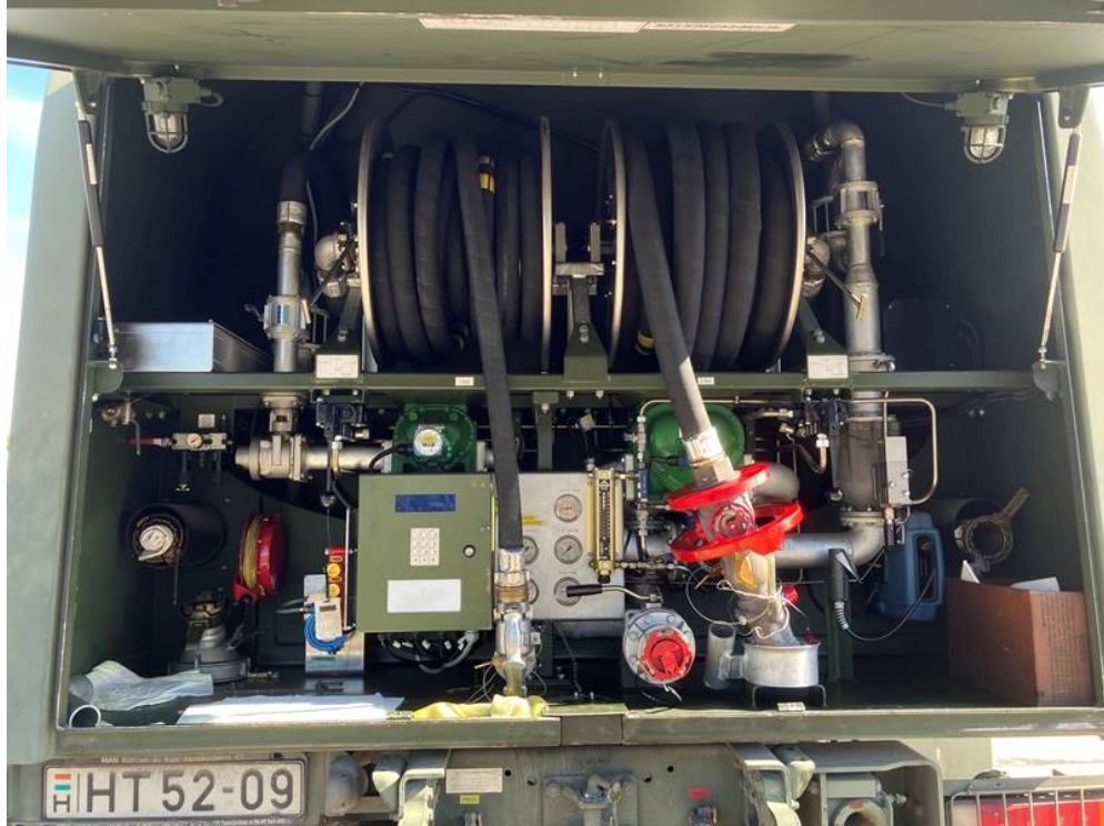
11. ábra Az ÜTG-18-asok esetében a jármű hátulján helyezkednek el a lefejtéshez szükséges kezelőszervek. A tömlődobok alatt kerültek beépítésre a zöld színű SAMPI átfolyásmérők (forrás: Saját felvétel)
