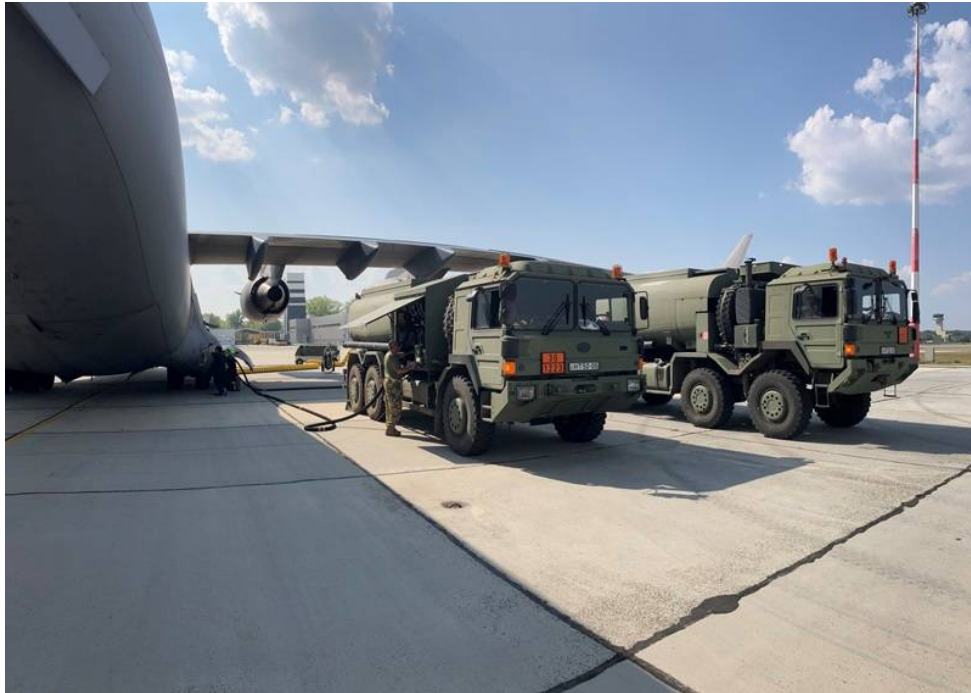
10. ábra Szimultán repülőgéptöltés egy ÜTG-10 és egy ÜTG-18 használatával (forrás: Saját felvétel)
