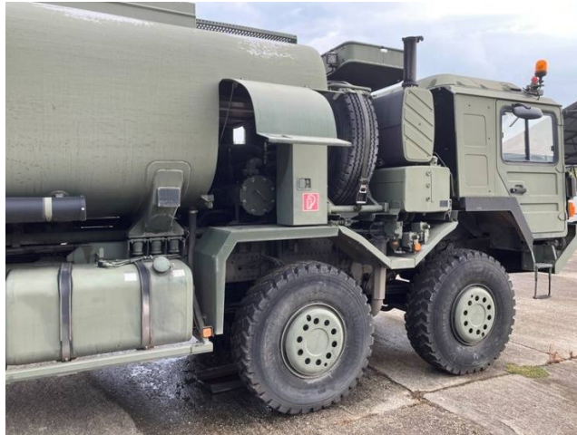
12. ábra az ÜTG-18-asok szűrőberendezése és szivattyúja a tartály és a fülke között kapott helyet. (forrás: Saját felvétel)
