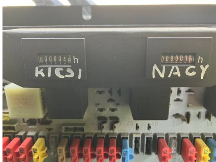
25. ábra HT 50-06 üzemóra számlálói. A kijelzett értékek valótlanok, 2005. óta folyamatos üzemelés esetén sem fordulhatott volna át az üzemóraszámláló. A számláló hibáját nem jelezték a kezelők (forrás: Saját felvétel)
