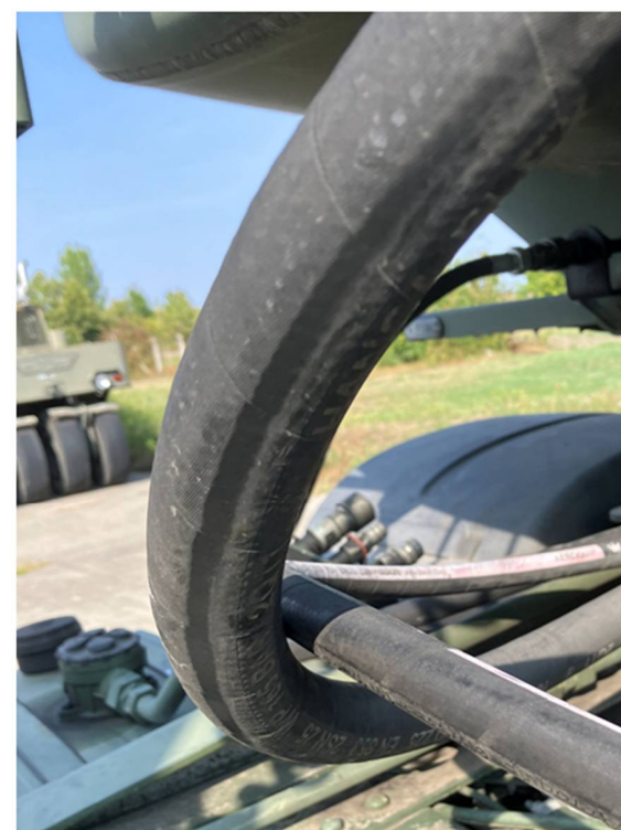
16. ábra A nyergesvontatók alváza és a hidraulika tömlők folyamatosan dörzsölődnek (forrás: Saját felvétel)
