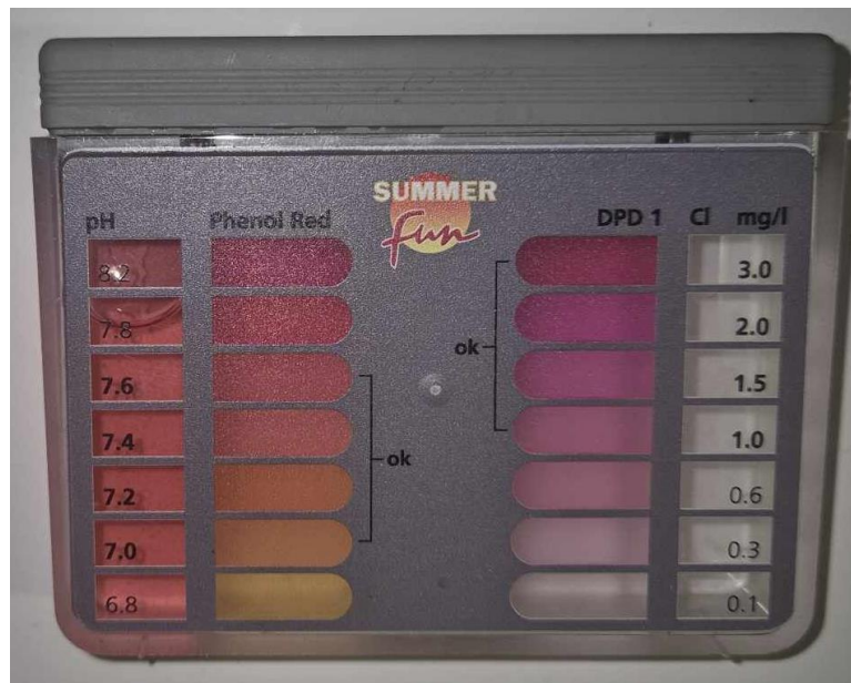
3. ábra: Öntözővíz pH szintjének mérése (saját ábra)
