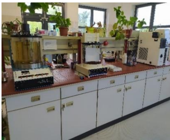
5.8. kép Viskoziméter fürdők és desztilláló berendezés
