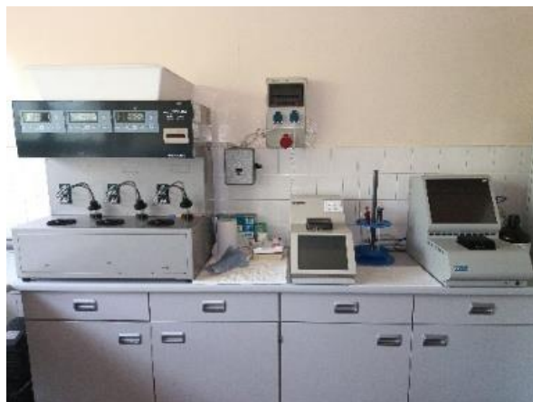
5.2. kép Kristályosodáspont mérők (FACE) és zavarosodáspont mérő
