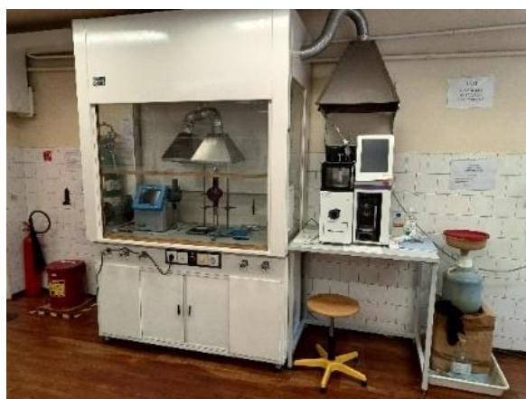
4.4. kép Gyűjtőpont technológiánál (SMOKE pont meghatározók és Desztilláló berendezés)
