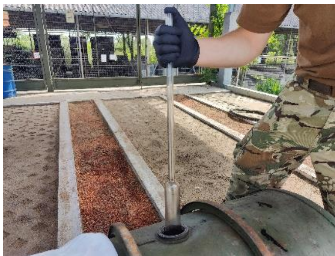
5.7. kép Vizuális vizsgálat hasas üvegcsővel
