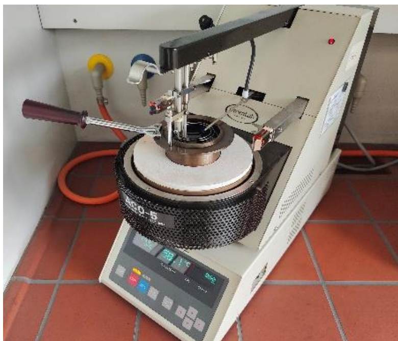
5.5. kép Cleveland Open-Cup készülék (COC)
