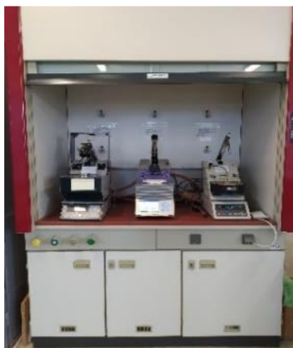
5.9. kép Zárttéri és nyílttéri lobbaspontmérők
