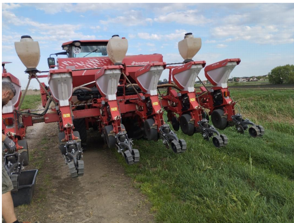
9- 10. kép: Szemenkénti vetőgépek típusai (forrás: saját)
