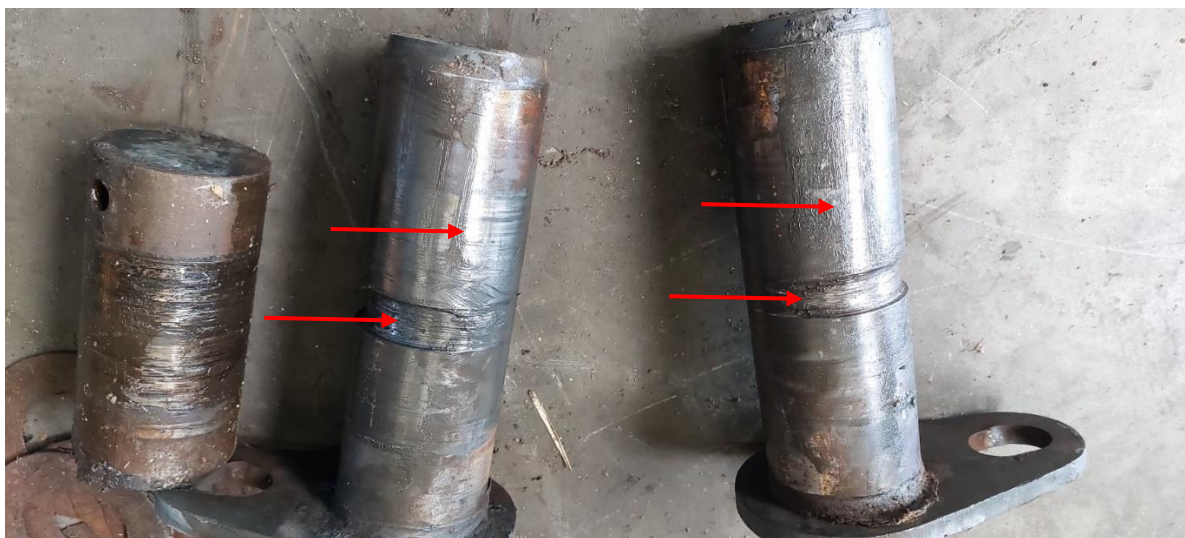
9. ábra: JCB 418 rakodógép gémcsapok kopása (adhéziós hegedési nyomok és abráziós karcok)
