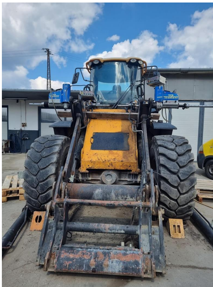
19. ábra: Vonalfűrés a JCB 418S rakodógépen
