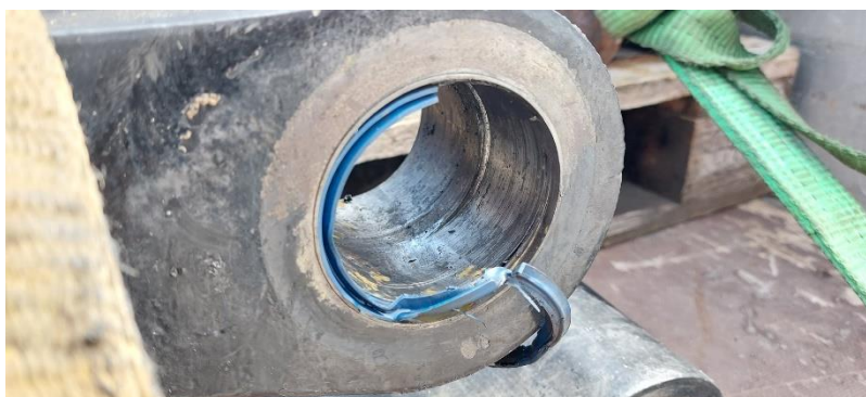
11. ábra: Rugós tömítőgyűrű sérülése JCB 418S rakodógépen
