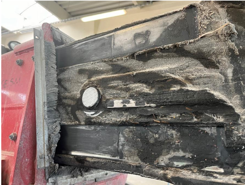
12. ábra: Szennyezett gép a Manitou 845 rakodógépen
