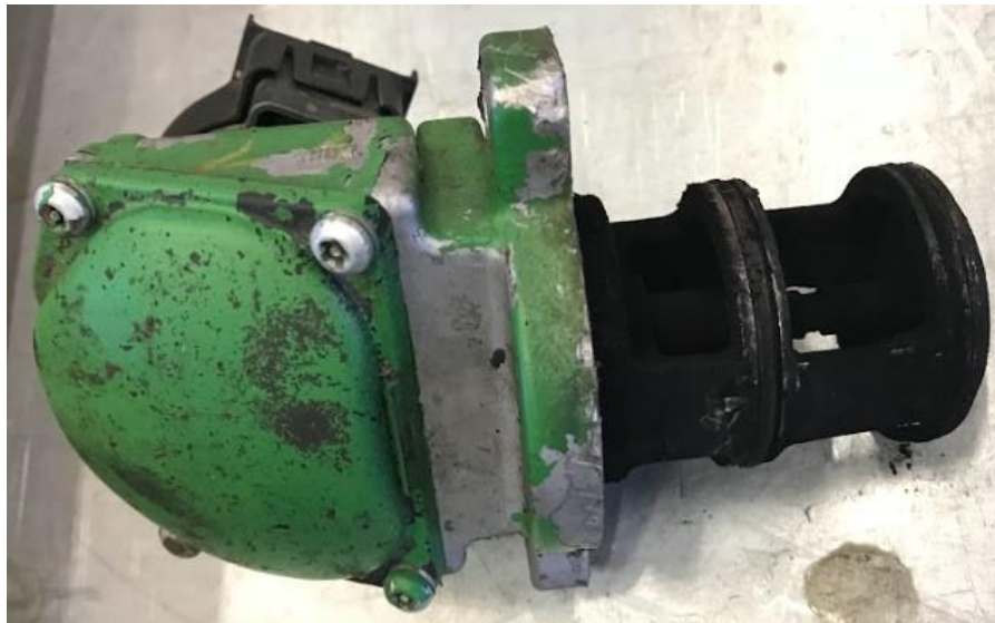
4. ábra: Elkormolódott EGR-szelep (saját forrás)
