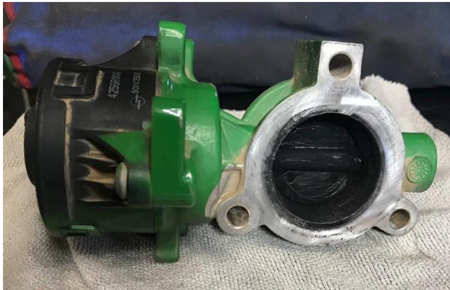
3. ábra: Elkormolódott EGR-pillangószelep (saját forrás)
