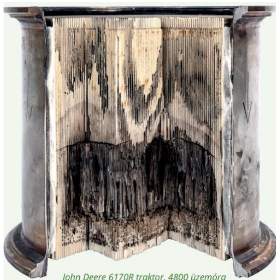
John Deere 6170R traktor, 4800 üzemóra 29.ábra: Összeégett DPF-szűrő
