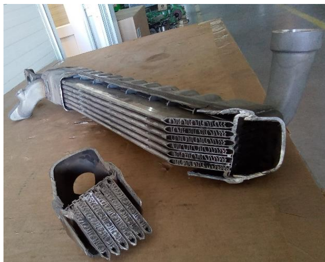
2 ábra: Elszennyeződött, átszakadt EGR hűtő (saját forrás)
