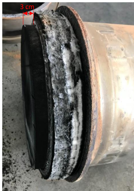
32.ábra: DPF kb 3cm-re kinyomott kerámia
