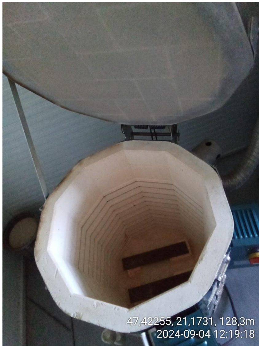
21.ábra: Hőkezelő kemence belső kialakítása (saját forrás)
