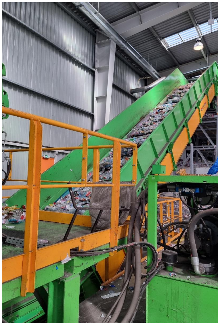
13. ábra: Felhordószalag a válogatóműben
