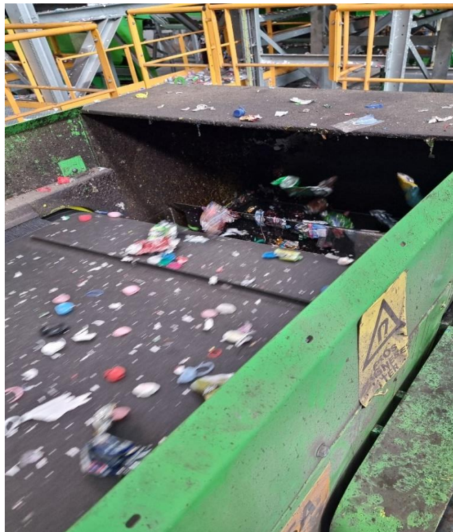
17. ábra: Mágnesezhető frakció kiválasztása a hulladékválogatóban (forrás: Saját készítésű fénykép)
