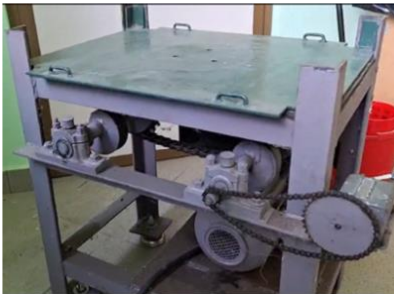
4. ábra Ejtőgép. Korábban használt mintagép láncajtással
