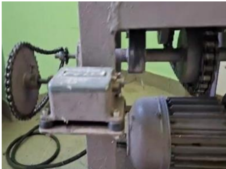
5. ábra Ejtőgép. Korábban használt mintagép veszélyes géprész
