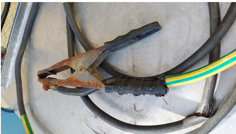
15. kép: Rozsdás, korrodált kábelcsipesz (Saját forrás)
