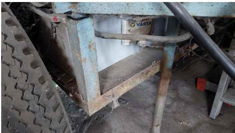
12. kép: Savfogó tálca hiánya (Saját forrás)
