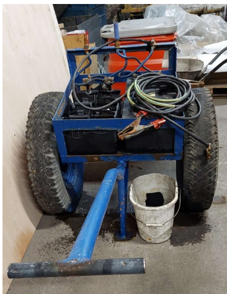
3. kép: Házilag készített indításrásegítő berendezés a robbanás után (Saját forrás)
