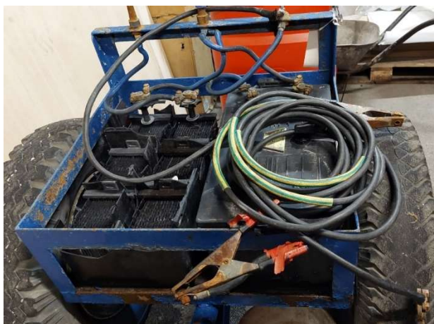
4. kép: A felrobbant akkumulátor és a házi készítésű indításrásegítő berendezés felülnézetből (Saját forrás)
