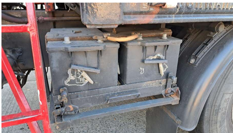
7. kép: Indításrásegítő az autóbuszmentő vontató teherautón (Saját forrás)
