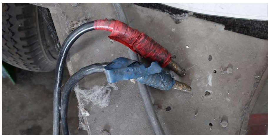
16. kép: Csipesz helyett rúd csatlakozás (Saját forrás)
