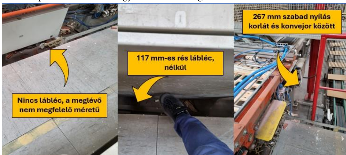
20. ábra – A kezelőálláson megfigyelt nemmegfelelőségek (saját kép)
