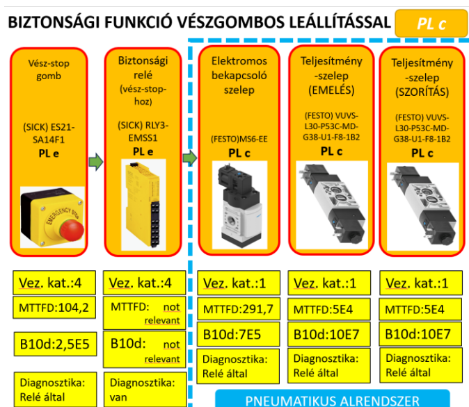
65. ábra, A biztonsági elemek és paramétereik, (vészgombos) (Forrás: saját munka)
