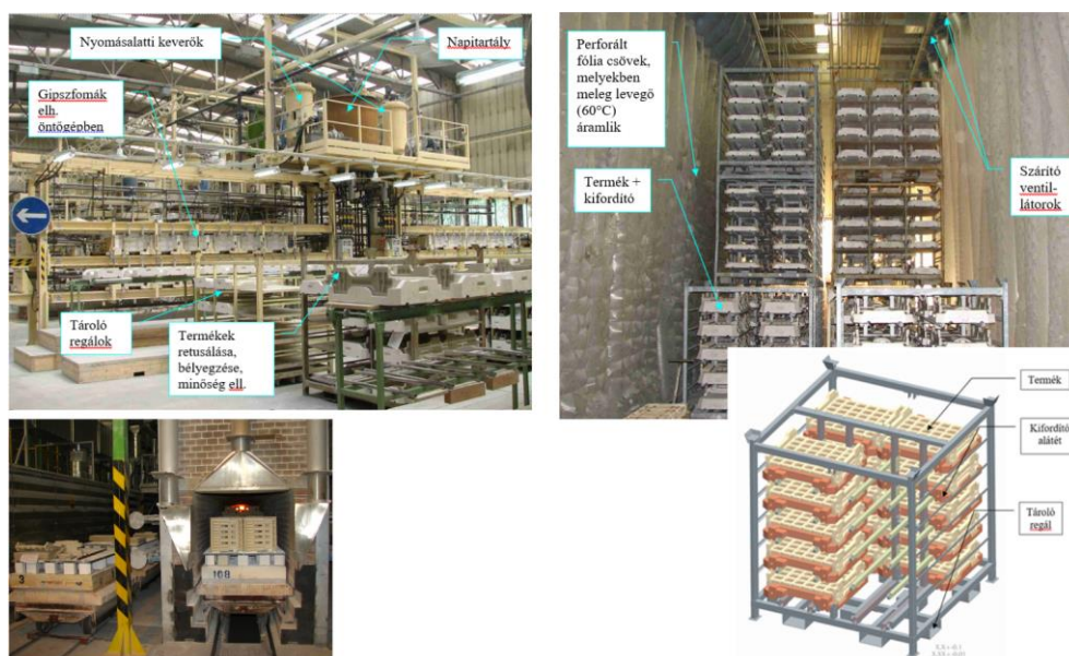
21. ábra, A H-tok gyártás (öntés-szárítás- kemence kocsira rakás) (Forrás: saját munka)
