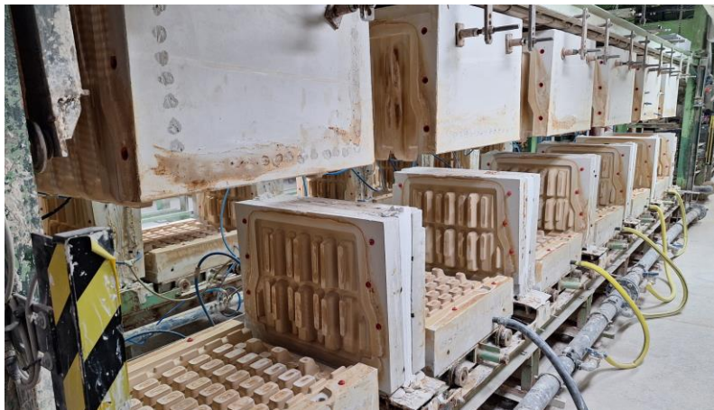
17. ábra, Gépi U-tok öntőgép formaelrendezése (Forrás: IMERYS Kft.)
