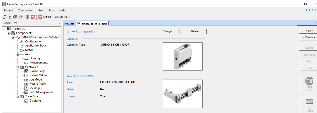
26. ábra: FESTO szervo konfigurálás
