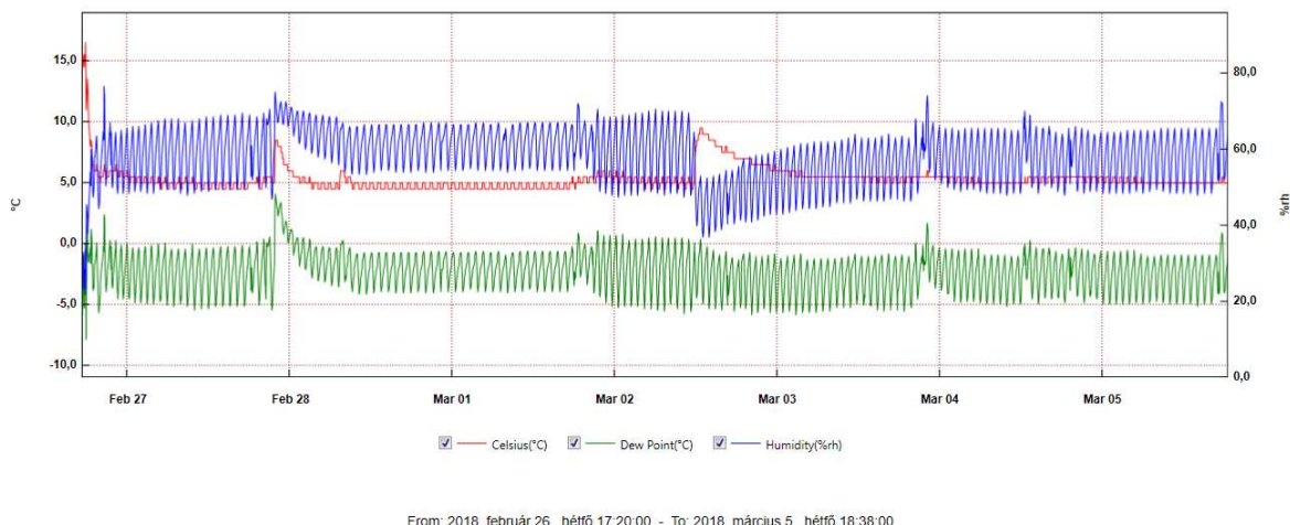
27. ábra: "V" hűtőjében egy hét alatt mért hőmérséklet-változások
