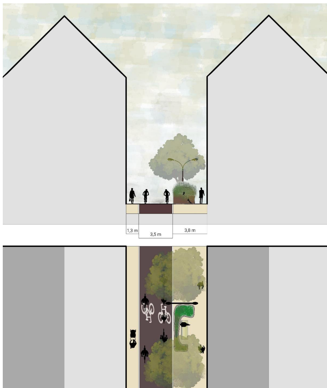
42. ábra Jellemző utcakialakítás keresztmetszet és felülnézet - maximalista javaslat 2024. Saját illusztráció
