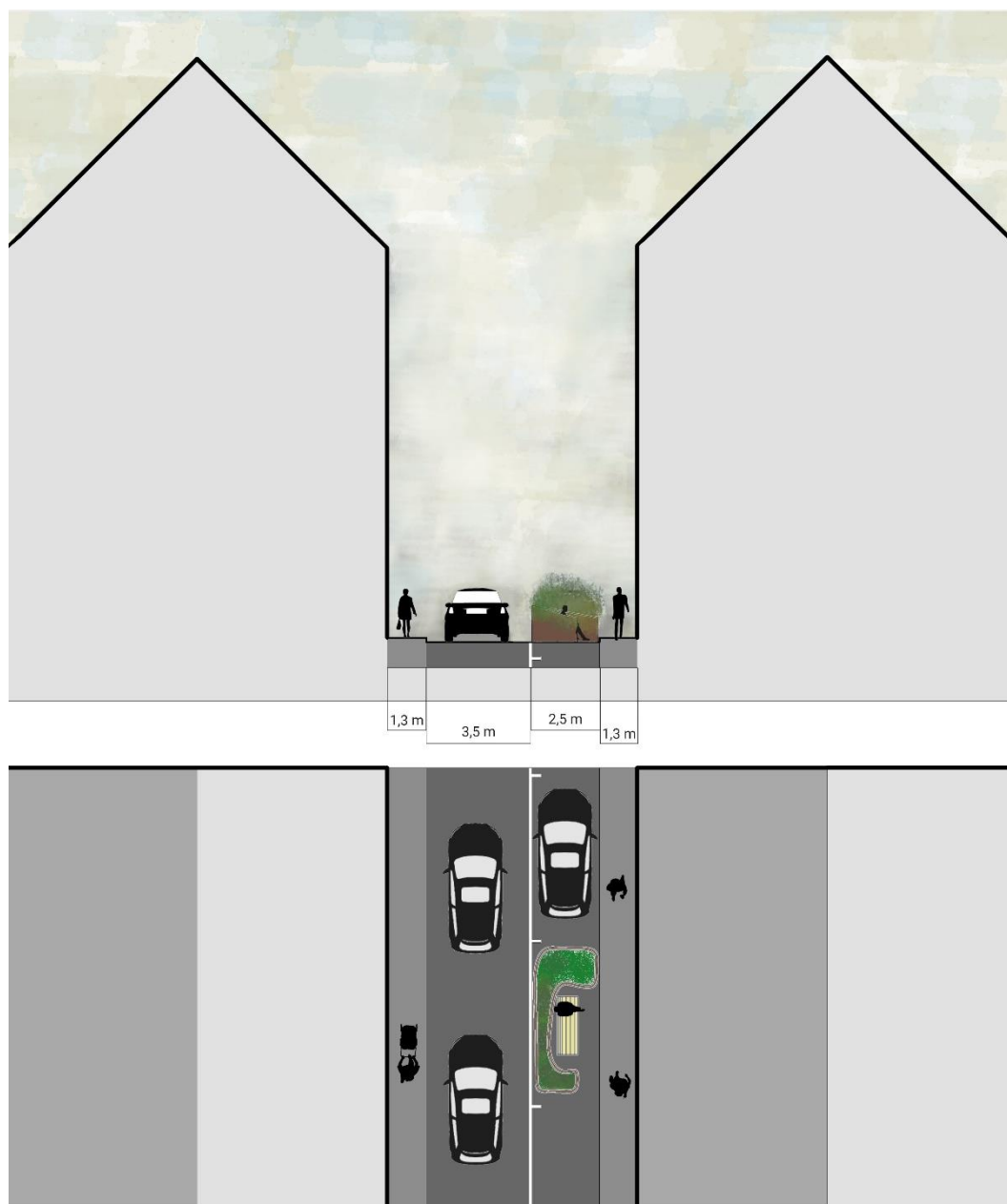
40. ábra Jellemző utcakialakítás keresztmetszet és felülnézet - minimalista javaslat 2024. Saját illusztráció
