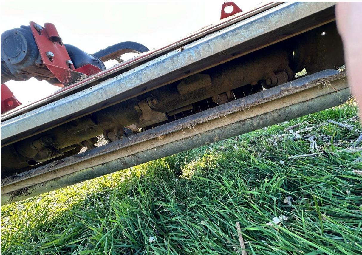
9. ábra (Vízszintes tengelyű szárzúzó kalapácsos száraprító késekkel szerelve, forrás: Saját kép)
