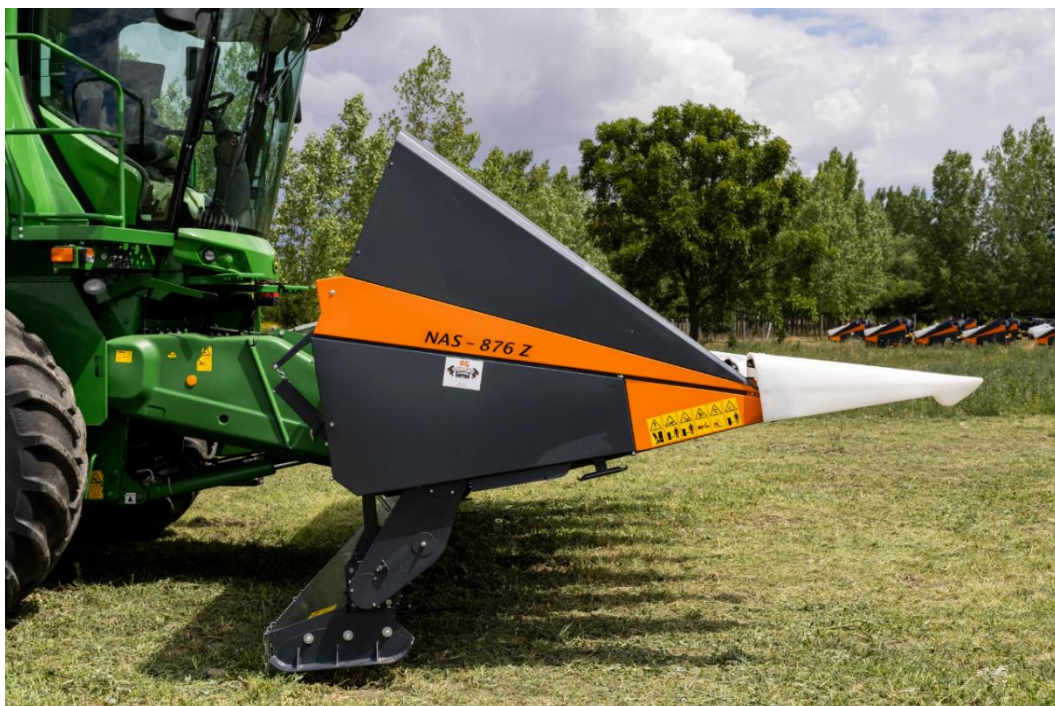
7. ábra (Nas-876 Z zúzóval szerelt napraforgó adapter, Forrás: https://4 )
