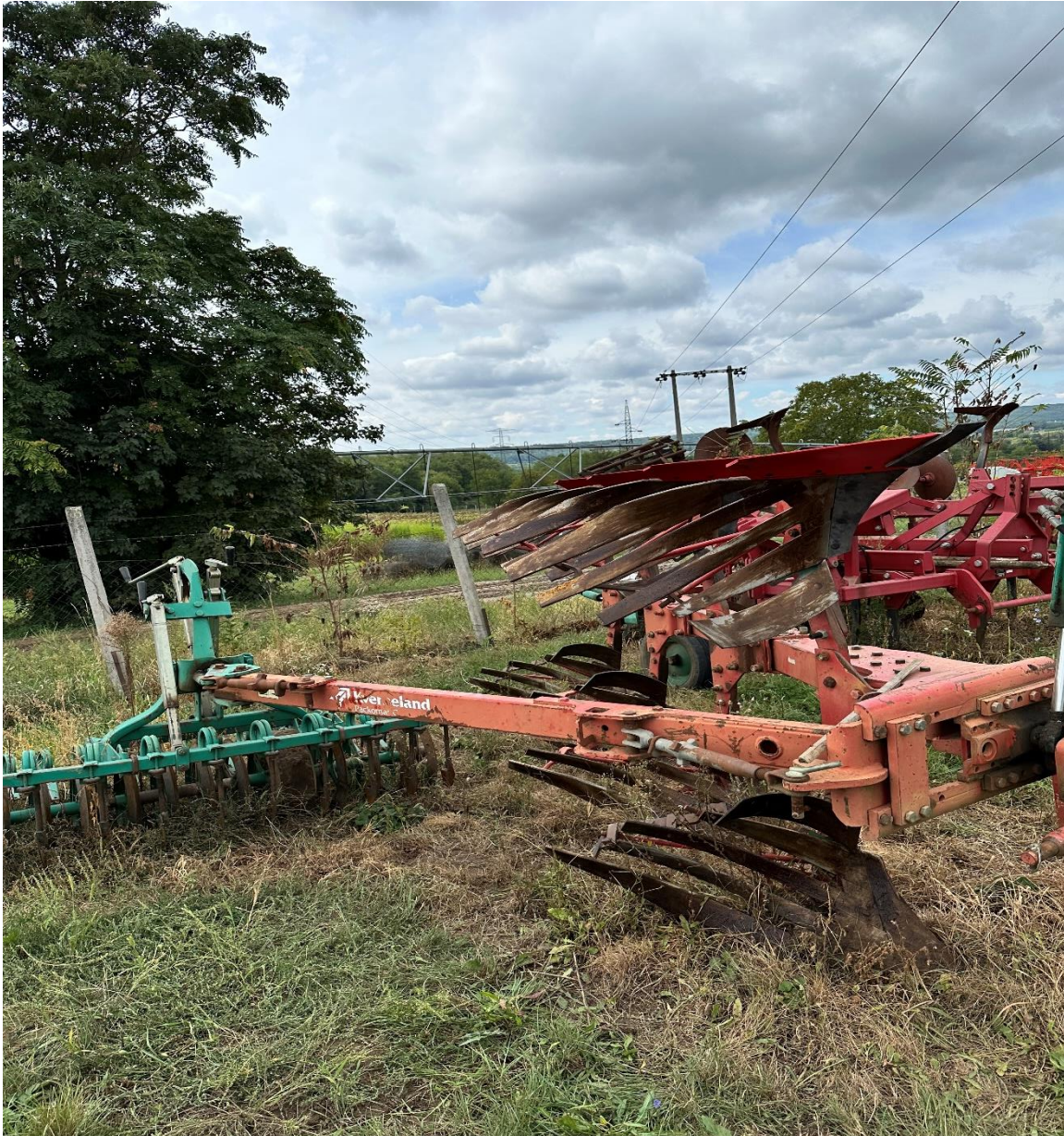
2. ábra (4 fejes váltva forgató eke szántáselmunkálással, forrás: saját kép)
