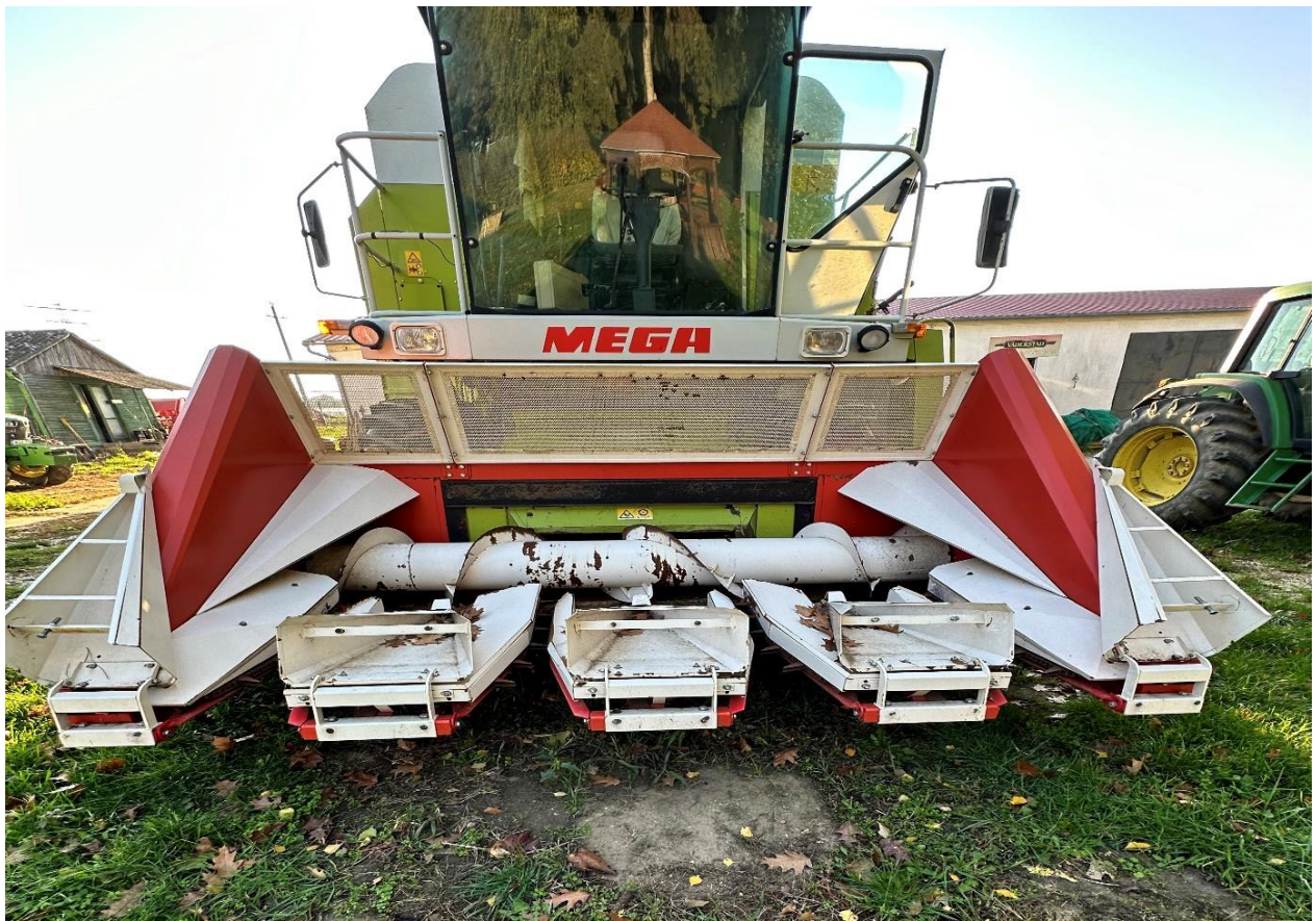
4. ábra (NAS 476 Soros, behúzó láncos, gyűjtőtálcás napraforgó adapter felcsukott orrcsúccsal szállítási helyzetben, forrás: saját kép)
