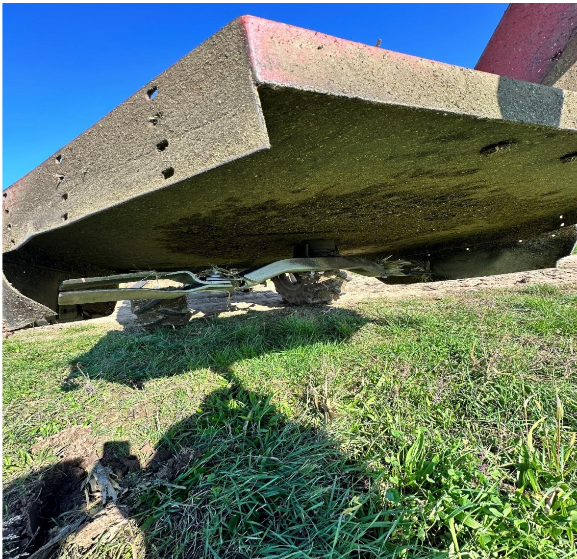
10. ábra (Függőleges tengelyű dupla késes száruzó, Saját kép)
