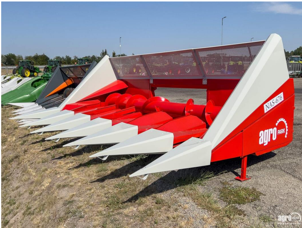
12. ábra (NAS 676 Soros, behúzólánccos, gyűjtőtálcás napraforgó adapter, forrás: https://6 )
