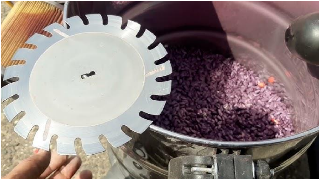
3. ábra (Horsch Maestro vetőgép napraforgó vetőtárcsája, forrás: https://2 )
