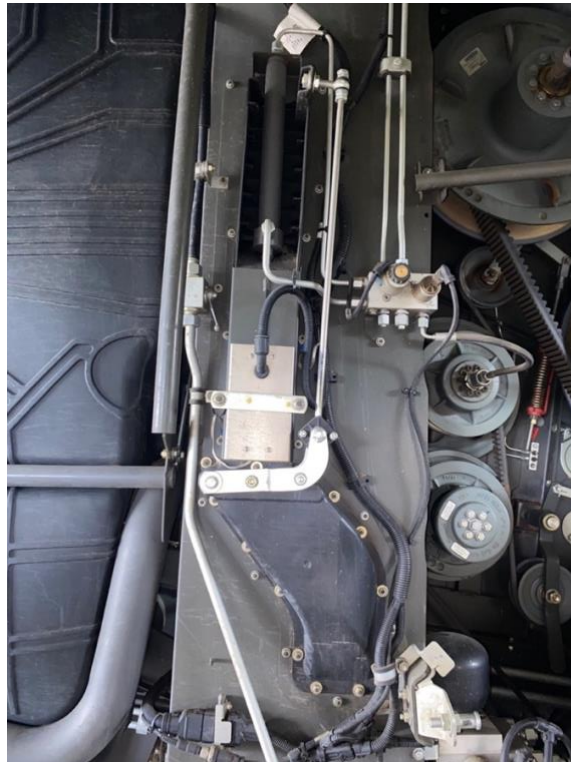
23. ábra: Magelevátoron elhelyezett szemnedvességmérő (forrás: Saját kép)
