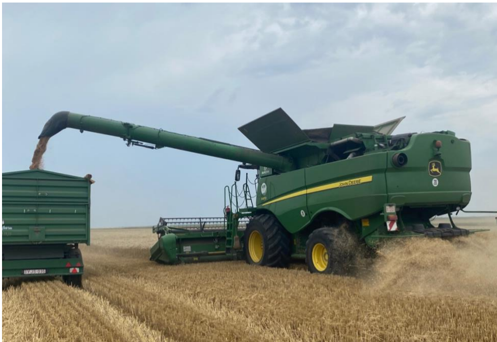
34. ábra: Magtartály ürítés közben (forrás: Saját kép)
