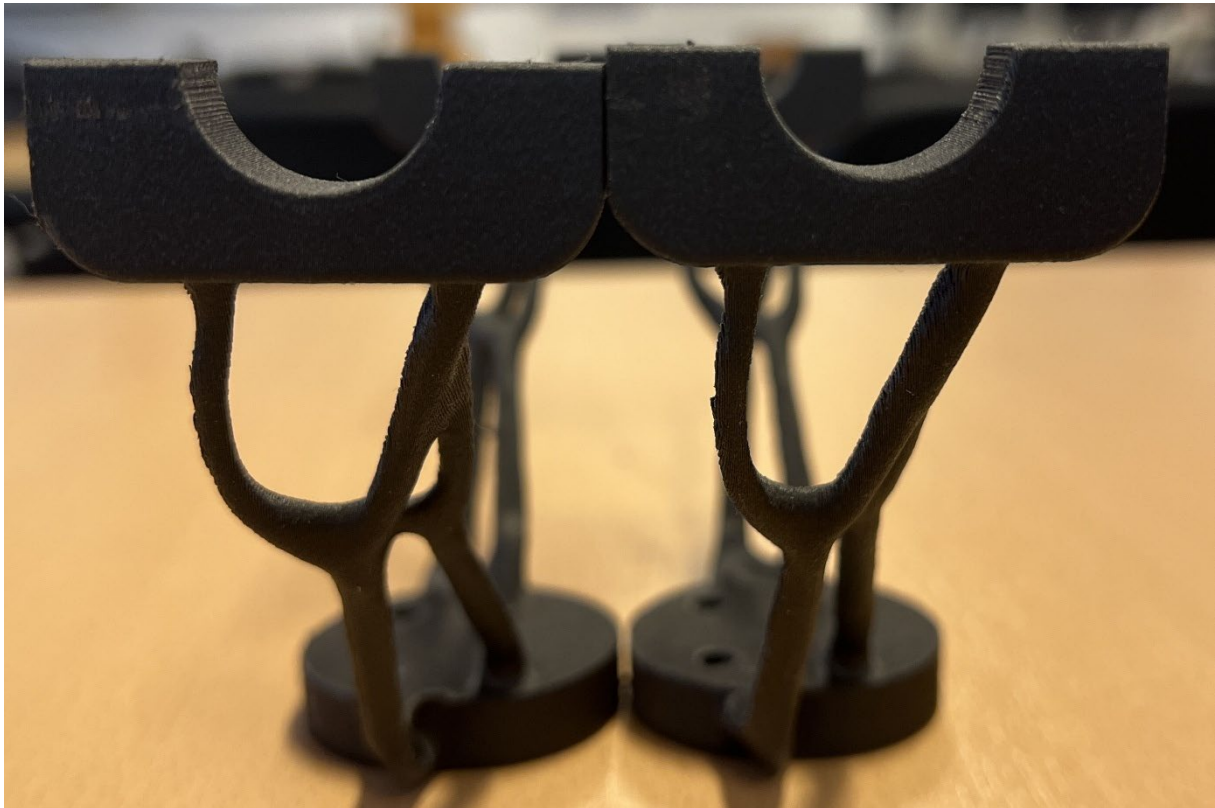
39.ábra Vizsgálat előtti (jobb) és vizsgálat utáni (bal) PA6-CF alapanyag (saját készítés)
