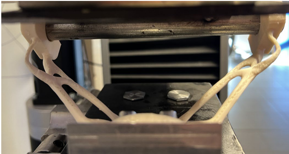
36.ábra Y irányultságú HYPER PLA kihajlása (saját készítés)
