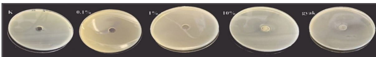
12. ábra: Az Eko-Sect Tron antibakteriális hatásának vizsgálata gátlási zóna alapján a különböző hígításokban 48 óra inkubálást követően (Fotó: Richter, 2023)
