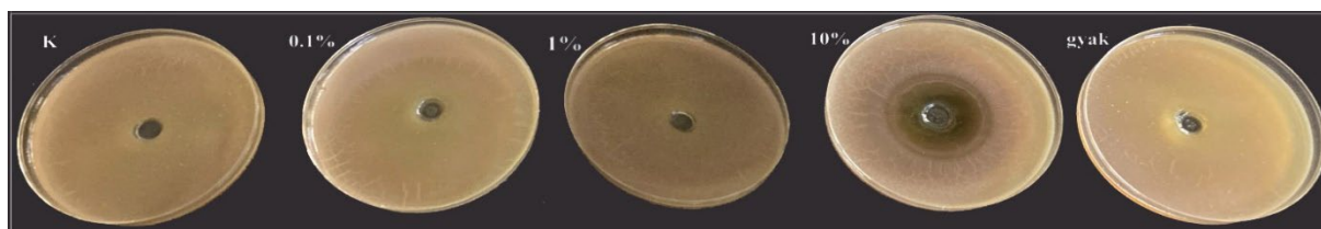
14. ábra: A Scudo antibakteriális hatásának vizsgálata gátlási zóna alapján a különböző hígításokban 48 órás inkubációt követően (Fotó: Richter, 2023)
