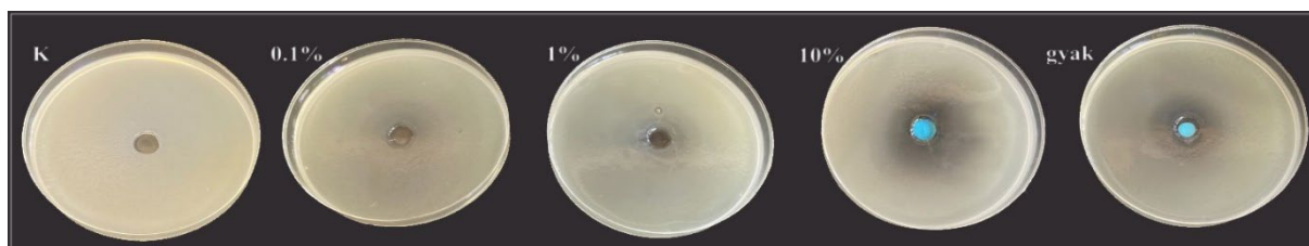
8. ábra: A Champion WG antibakteriális hatásának vizsgálata gátlási zóna alapján a különböző hígításokban 48 órás inkubációt követően (Fotó: Richter, 2023)
