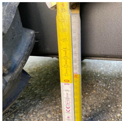
15. ábra: hasmagasság mérése Fényképezte: Hajdu Máté
