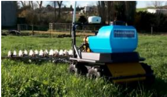
5. a ábra: az A200-as robotra felszerelt IoT szenzorcsomag Forrás: Bourhane, 2021
