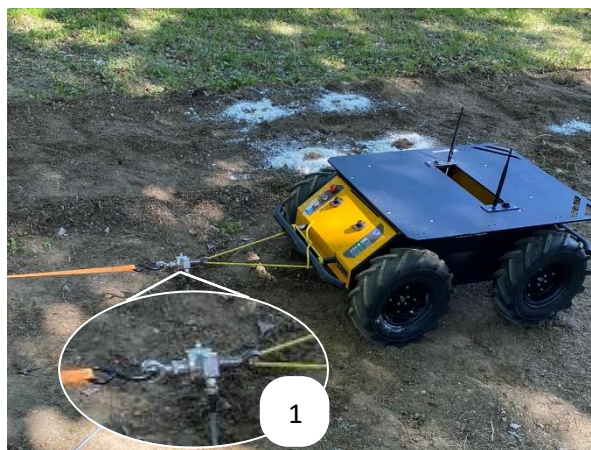
13. ábra: a vonóerőmérés kialakítása Fényképezte: Hajdu Máté
