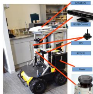
6. b ábra: az A200-as robotra felszerelt IoT szenzorcsomag Forrás: Bourhane, 2021
