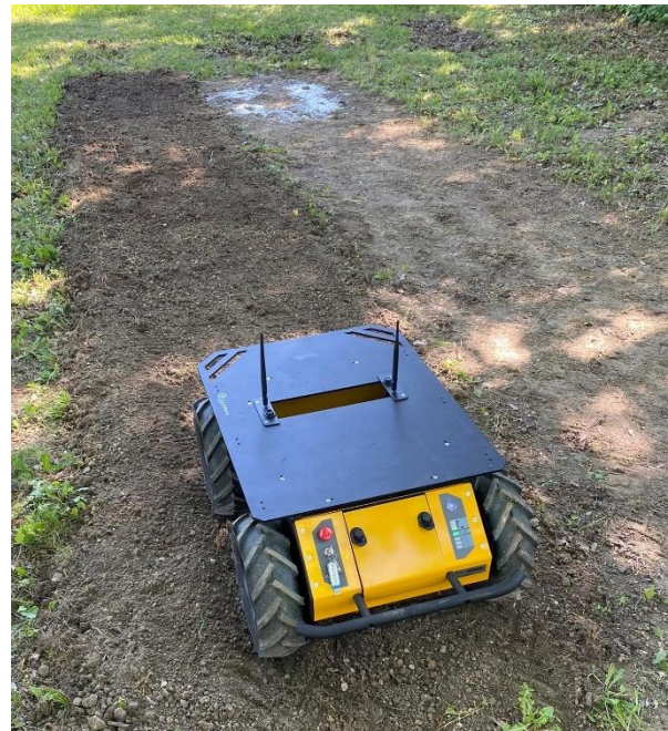
14. ábra: gördülési ellenállás mérése Fényképezte: Hajdu Máté
