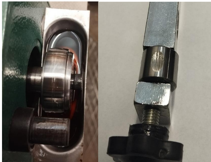
5. ábra Gyűrű és henger kopása egy mérés alatt (forrás: saját kép)
