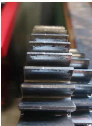
14. ábra Kopott fogaskerék
