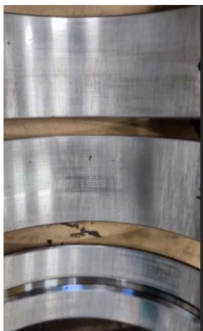
16. ábra Kopott főtengelycsapágyak
