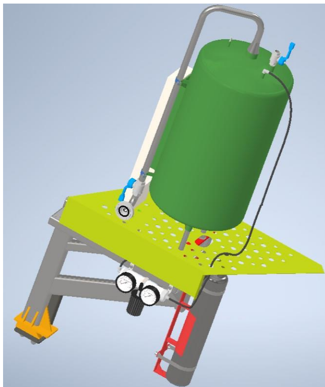
18. kép Elkészült tűzoltórendszer 3D modellje (Forrás: saját kép)
