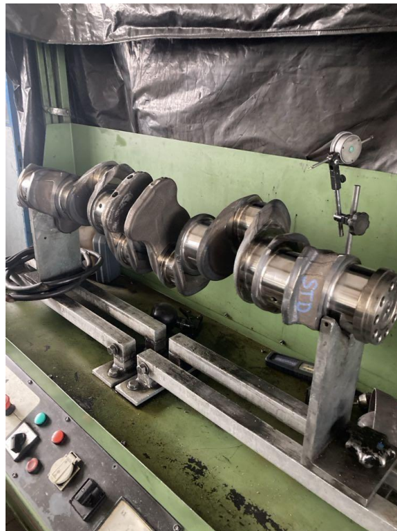
24.ábra: Forgattyús tengely hibafeltárása
