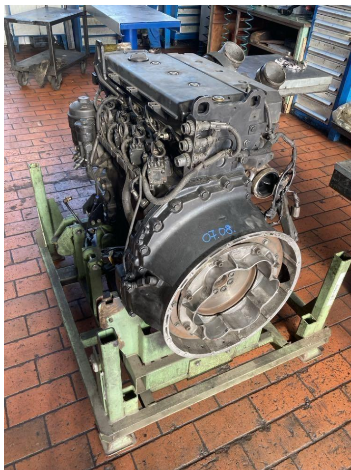
16. ábra: Volvo D7C 275 kiszerelt állapotban, hibafeltárás előtt
