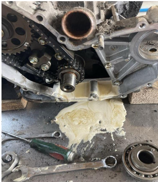
20.ábra: Hűtővíz és olaj keveredésének következménye
