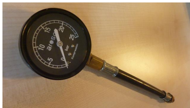
12.ábra: Kompressziómérő berendezés
