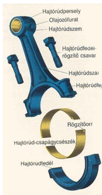
5.ábra: Hajtórúd felépítése
