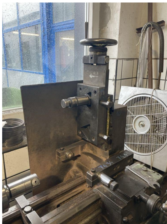
22.ábra: Hajtórúd befogatására szolgáló eszköz
