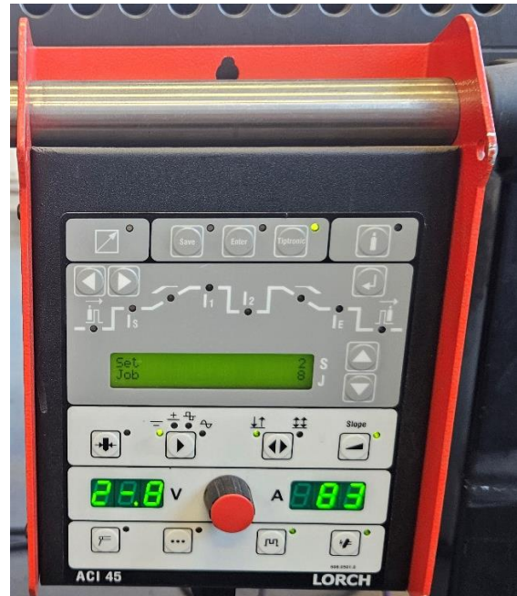
2. ábra: Modern hegesztőgép és a hegesztő vezérlőpanelje
