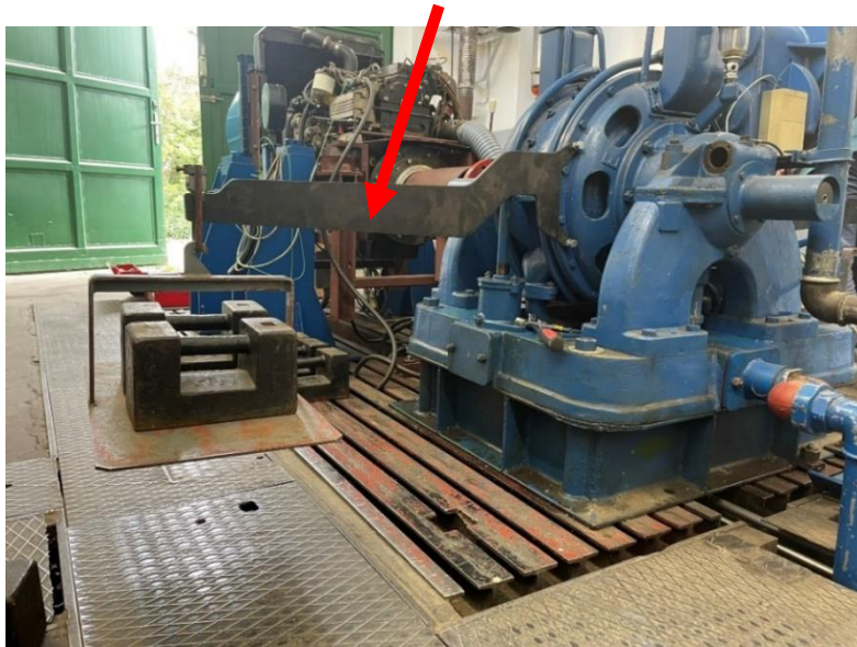
9. ábra: Kalibráló kar felhelyezve, Forrás: saját kép
