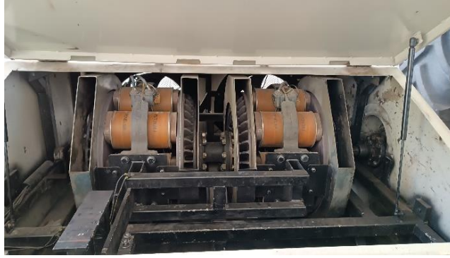
15. ábra: Mobil fékpad belső felépítése
