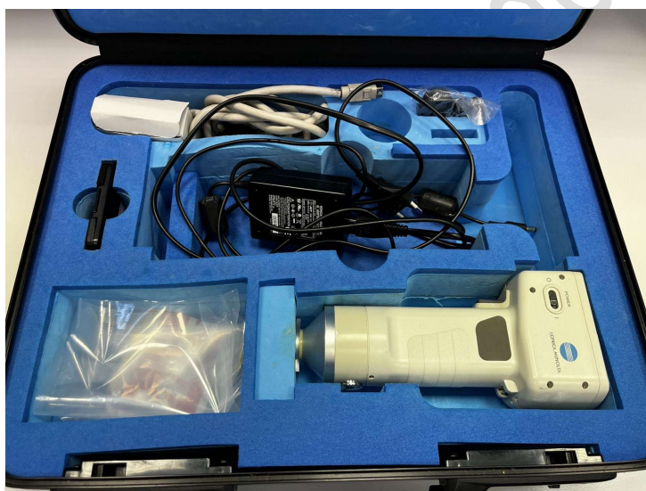
6. ábra: Konica Minolta CR 400-as kézi színmérő berendezés (forrás: saját készítésű kép)
