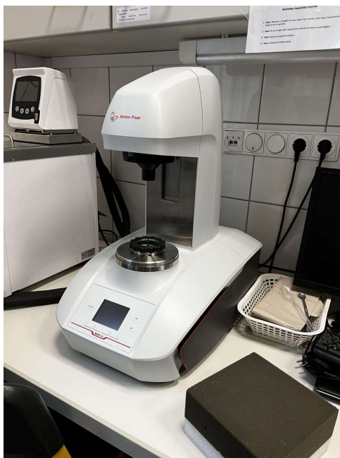
9. ábra: MCR92 Anton-Paar reométer (forrás: saját készítésű kép)
