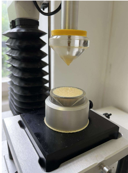
7. ábra: Az SMS TA.XT állománymérő gép két mérés között a használt mérőfejjel és a mérő cellával, benne a mintával (forrás: saját készítésű kép)
