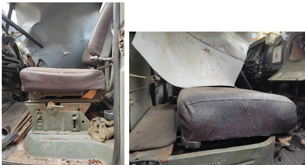
5. ábra PILOT P405 A 100 H integrált biztonsági övvel ellátott ülés
