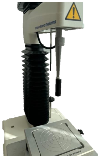
12. ábra SMS Texture analyser állományvizsgáló műszer (Forrás: Saját kép)
