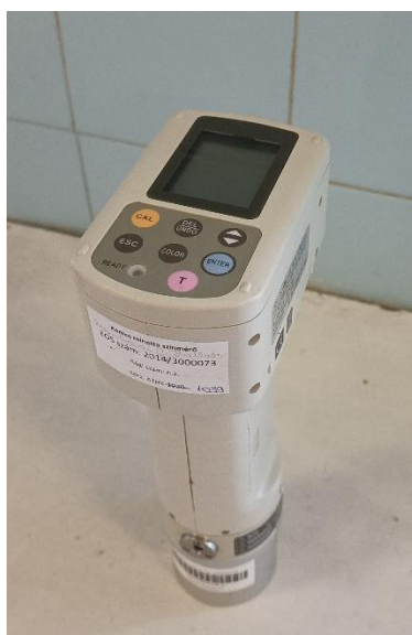
6. ábra: Hússzín mérése CR-410 Konica Minolta kromaméterrel (Sipiczki 2024)
