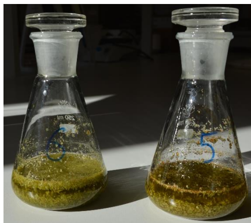
16. ábra: Toluolos kivonatolás (Forrás: Saját fénykép)
