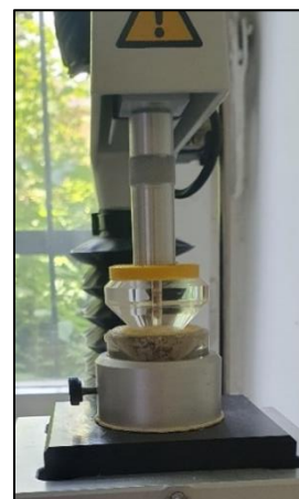
10. ábra: Állomány mérése kenhetőségi feltétellel SMS TA.XT Plus műszeren II.
