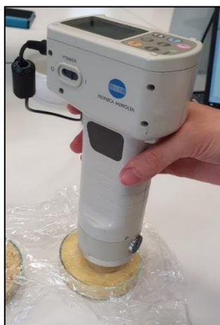
5. ábra: Mérés Konica Minolta kézi színmérővel
