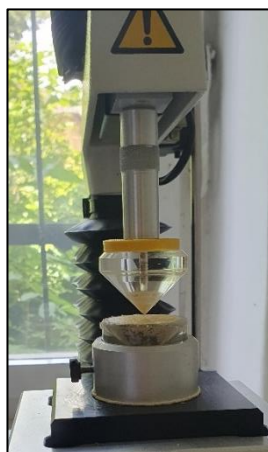
9. ábra Állomány mérése kenhetőségi feltétellel SMS TA.XT Plus műszeren I.
