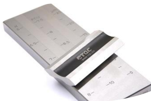
4. ábra: TQCVF2124 típusú kétcsatornás grindométer (forrás: http 3 )
