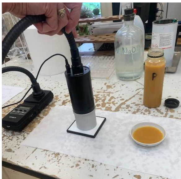
9. ábra: Színmérő műszer kalibrálása
