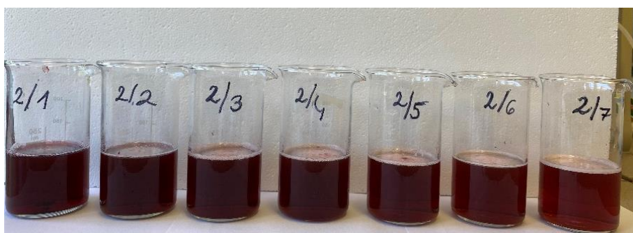
15. ábra: 2-es mintasor oldhatósági vizsgálat (1. perc) (Forrás: saját fénykép)
