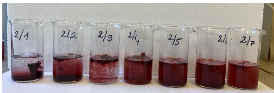
15. ábra: 2-es mintasor oldhatósági vizsgálat (1. perc) (Forrás: saját fénykép)
