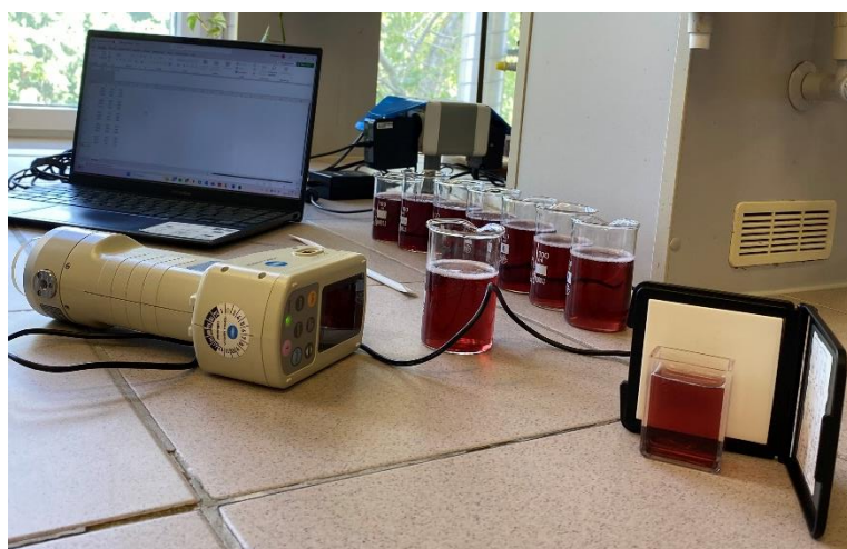
5. ábra: Színmérés Konica Minolta színmérő készülékkel (Forrás: saját fénykép)
